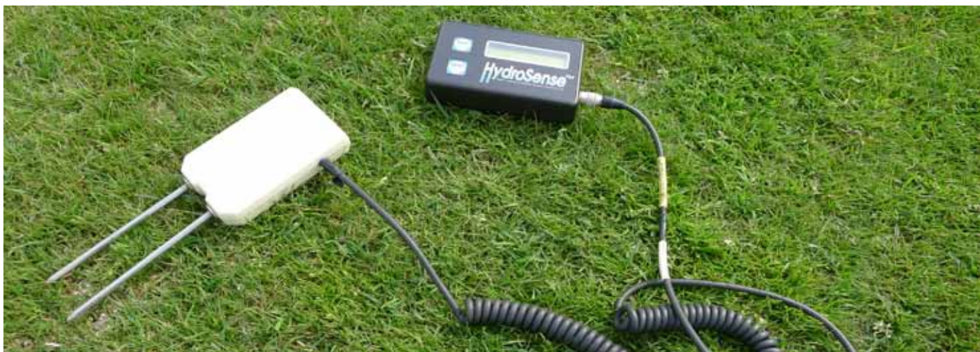
En TDR måler aflæser det gennemsnitlige vandindhold i procent. Det er et godt hjælpemiddel til at bestemme behovet for kunstvanding. Flere målinger kan vise hvor jævnt vandet er fordelt og bidrage til at afdække tørkepletter, før de bliver synlige. Foto: Agnar Kvalbein
