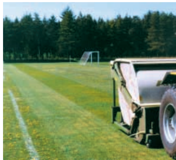
Vertikalskæreren river filtaget op og skærer ukrudtets blade over. Maskinen samler materialet op.
