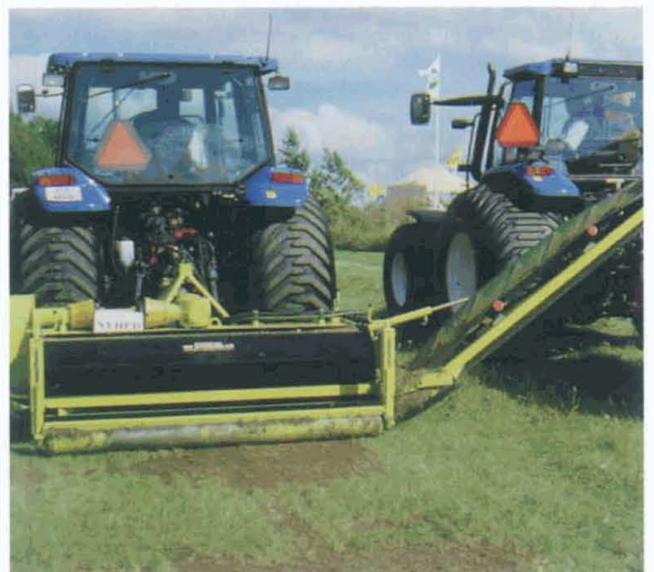
Topskrælning består i at de øverste 1,5-3,0 cm af overfladen skrælles af ved hjælp af en fræserlignende maskine. Ved selve behandlingen udjævnes overfladen samtidigt med at uønsket græs og ukrudt fjernes.
