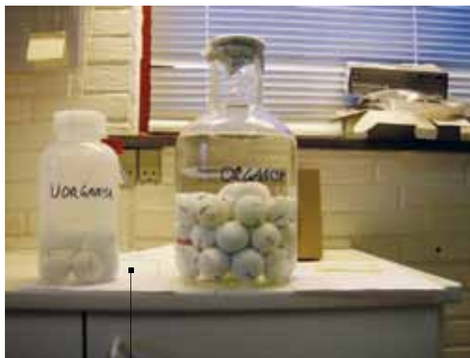
Forsøgsopstilling hvor de forurenende stoffer udvaskes i to tests for dels uorganiske dels organiske forbindelser.
